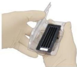
**Figura 5-2: Inspecione a célula de fluxo**
