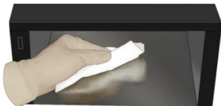
**Figura 6-13: Mantenha o compartimento de reagentes**
