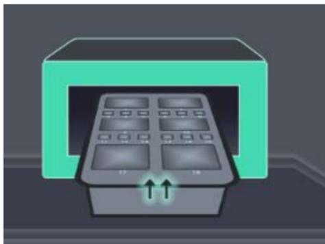
**Figura 6-14: Deslize o novo kit de reagentes no compartimento de reagentes**
